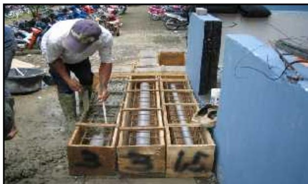
Gambar 1. Pengecoran benda uji
